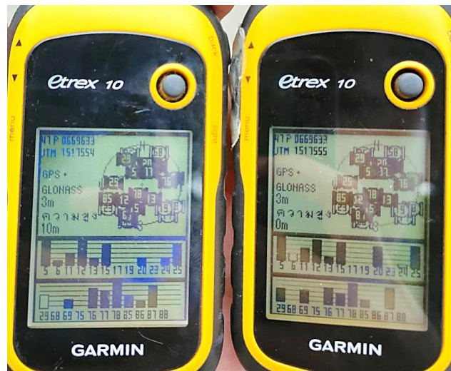
ภาพที่ 3 การสอบเทียบเชิงตำแหน่งของอุปกรณ์รุ่นเดียวกันเครื่องระบุตำแหน่งบนพื้นโลก (Global Positioning System: GPS) ยี่ห้อ Garmin รุ่น Etrex® 10
