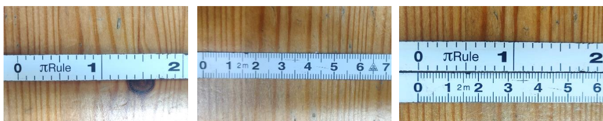
ภาพที่ 1 การสอบเทียบอุปกรณ์ Diameter Tape ยี่ห้อ KDS รุ่น F10-02DM
