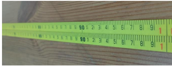
ภาพที่ 2 การสอบเทียบอุปกรณ์และตรวจสอบความสมบูรณ์ของอุปกรณ์เทปวัดระยะ ยี่ห้อ Stanley รุ่น Fiberglass Long Tape Rule 34-260
