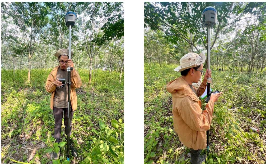
ภาพที่ 4 การจับพิกัดขอบแปลงด้วย RTK หรือ Real-Time Kinematic survey
